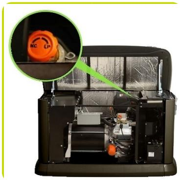
Примітка: Паливна труба повинна бути розрахована на максимальне навантаження. Необхідний тиск пального на вході генератора при всіх рівнях навантаження становить 0.87-1.74 кПа (3.5"-7" водяний стовп) для природного газу і 2.49-2.99 кПа (10-12" водяний стовп) для зрідженого газу.
